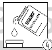
Шаг 4 - Нейтрализация кислотности теплообменника
